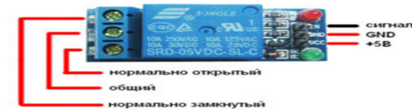
Сурет 4 – Ардуиноны магнитті қосып, ажыратуға арналған реленің схемасы
